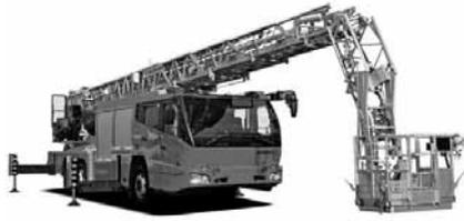
最新型のはしご車(イメージ)。先端が屈折することでベランダ内部などにも侵入できます。
