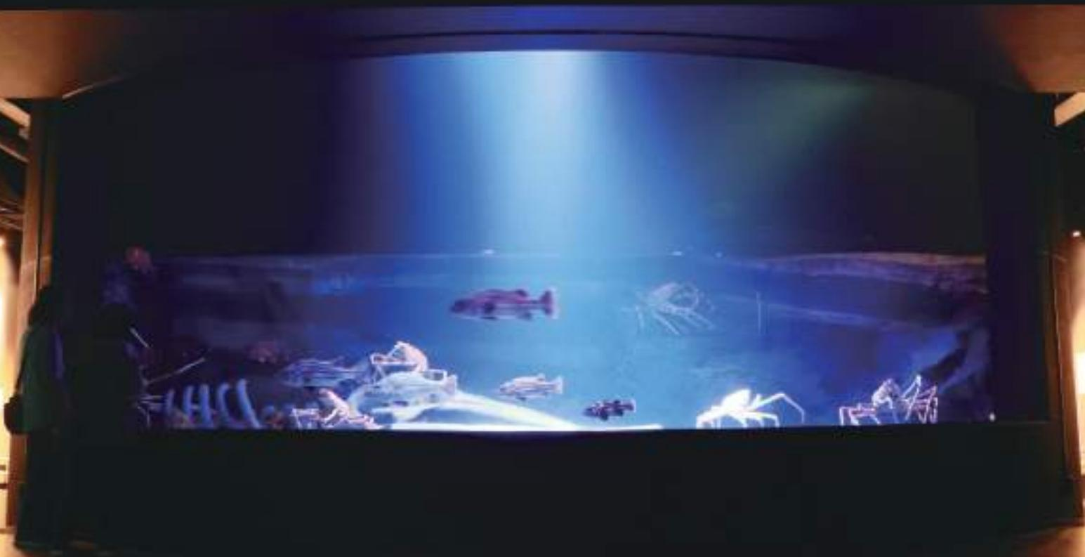
幅7メートルの曲げガラスを使用し、奥行き7メートル、高さ3メートル、水量120トンという、国内有数の深海生物の水槽です。
