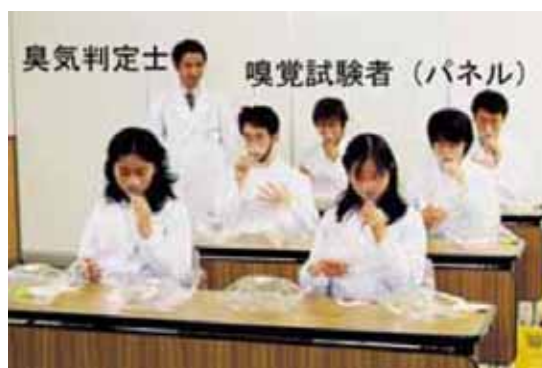
写真 悪臭臭気嗅覚測定の様況
