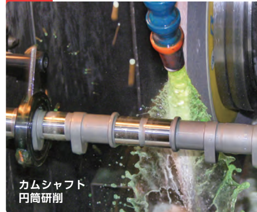
エンジンカムシャフト (材質: 鍛造総削り)
