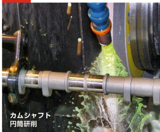
エンジンカムシャフト (材質: 鋳造総削り)
