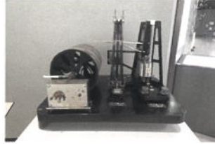
三河地震の波形を計測した [今村式二倍強震計] [岐阜県博物館 所蔵]
