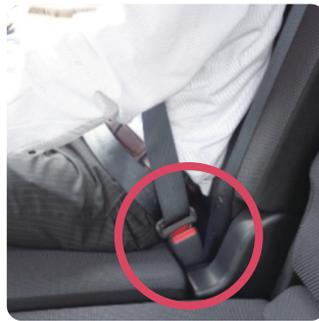
金具は確実に差し込む。ベルトのねじれにも注意。
