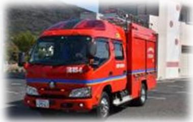
小さな車の性質を利用して、通常の消防車ではせまくて入ることがむずかしい道路を走行することができます。また、消火栓から水を吸い、他の消防車へ水を送る大事な仕事をします。
