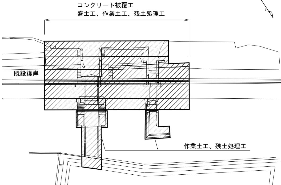
構造物撤去工平面図 (縮尺1/500)
